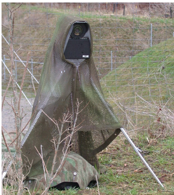
Abbildung 2: Videoüberwachung mit einer Infrarot-Kamera (Foto: B. Schlup, PiU GmbH).
