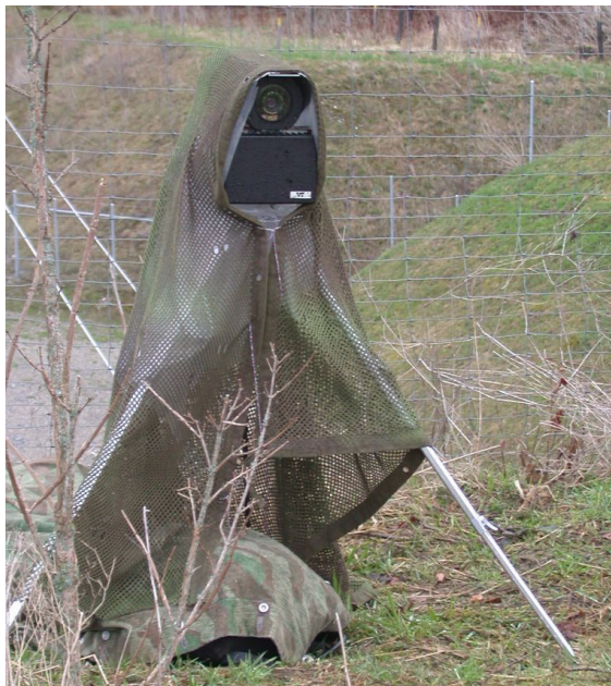
Abbildung 2: Videoüberwachung mit einer Infrarot-Kamera.
